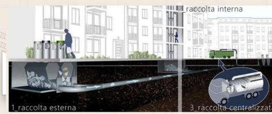
**SISTEMA DI ASPIRAZIONE RIFIUTI E RACCOLTA CENTRALIZZATA**
